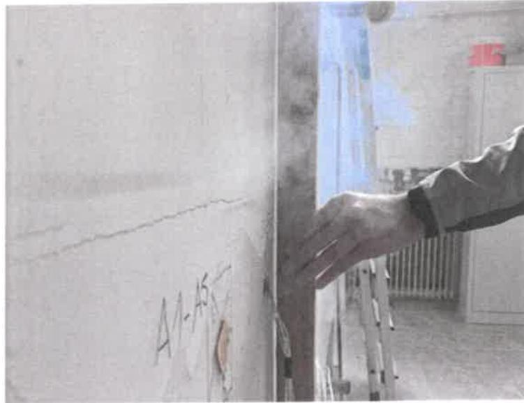
**Bild 8: Rissbildung und Verformung der Brandabgewandten Seite nach 70 Minuten**
