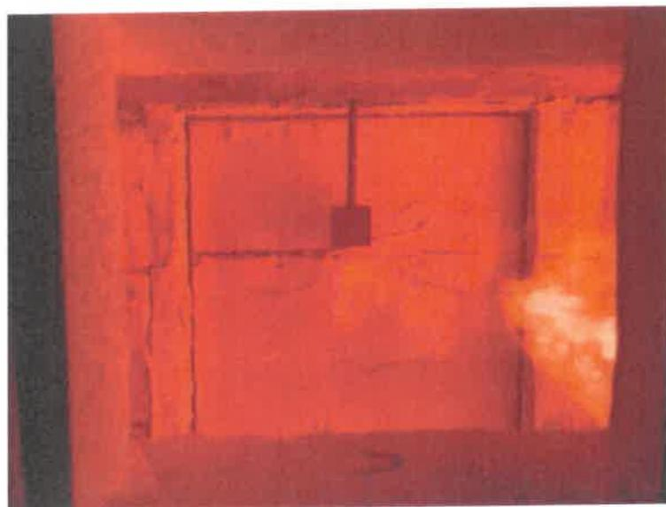
**Bild 7: Querfuge und äußere GKF-Platte auf der Ofenseite nach 60 Minuten**
