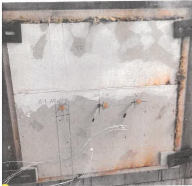
**Bild 10: Prüfkörperansicht von der brandabgekehrten Seite nach 92 Minuten**
