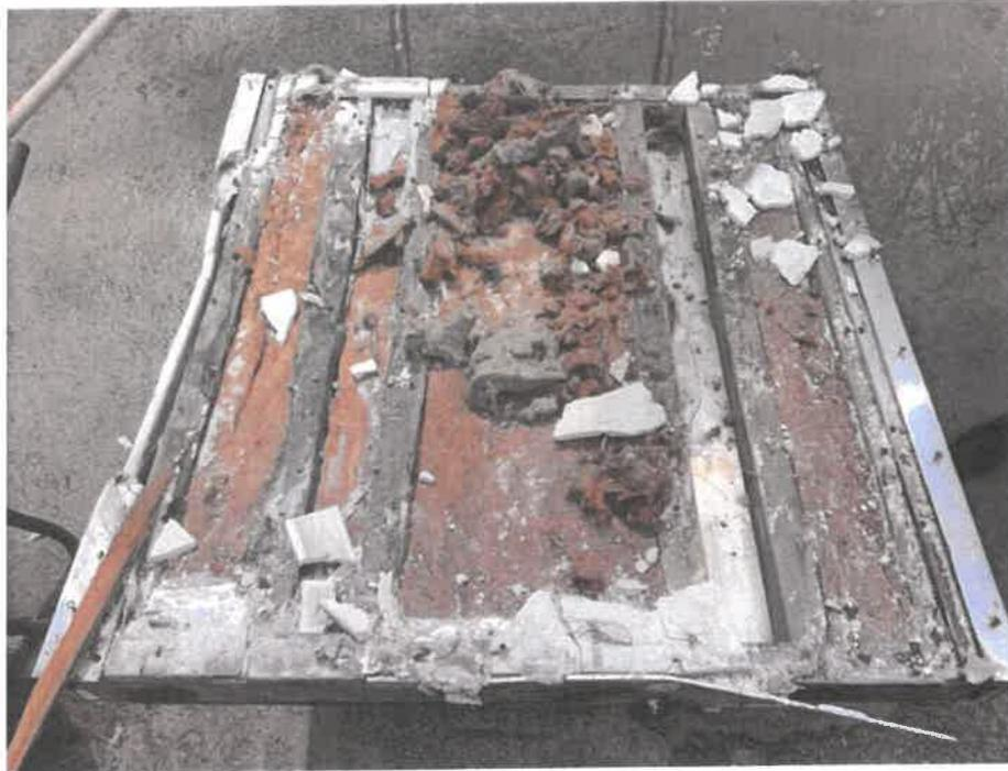
**Bild 19: Bauteil mit entfernten GK-Platten von der brandzugekehrten Seite**
